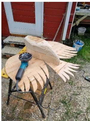
Das Schnitzen der Form aus einem Holzklotz heraus (Winkelschleifer mit Schnitzaufsatz) war doch etwas anspruchsvoller, aber machbar. Styropor und Spachtelmasse für die Konturen der Flügel folgten.
